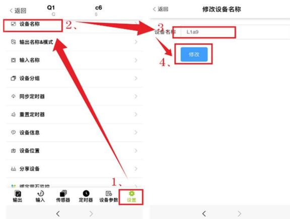
(2)、输出名称&模式：修改每一输出通道的名称及输出通道模式，列如：点击“设置”选择“输出名称&模式”（可设置输出通道名称、设置模式），然后点击“修改”确定。
