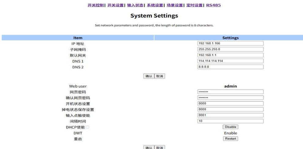
设备支持动态获取 IP 和静态 IP 功能，如需启用动态获取，使能 DHCP 按钮即可，如需配置静态 IP 则需要配置 IP 地址和默认网关，此处 IP 地址和默认网关需要匹配；
