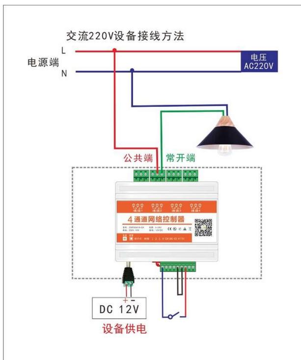
产品介绍：产品设备上方 4 组继电器输出接线端。设备下方从左到右依次是：外部电源输入（供电电源 12V）、初始化按钮（用于初始化网络参数，\*\*\*请勿操作）、信号指示灯、网线接口（连接到路由器或者电脑通讯）、1—4 输入端、COM、GND、VCC、RS485-A、RS485-B 端。
